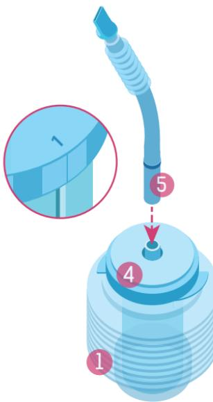
ка соединяется своей короткой частью 5 с выступом на крышке стакана. Таким образом, гофрированная емкость находится в сжатом состоянии.
